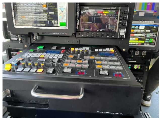
写真6 VE卓 映像SWや音声 MIXSW FPU 操作
